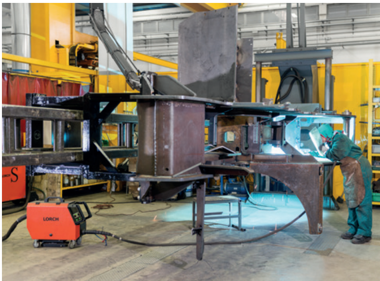
Ideal bei großen Bauteilen: Mit der Powermaster-Fernregelung können Schweißparameter direkt am Brenner eingestellt werden
