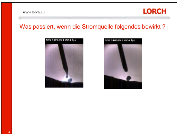
Bilder des Werkstoffübergangs: Links SpeedPulse, rechts konventioneller Puls
